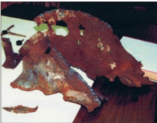
Echantillon n°1 (WTC7) : état de "corrosion avancée" et "fusion intergranulaire"
