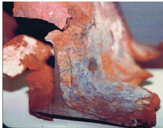
Echantillon n°1 (WTC7) : état de "corrosion avancée" et "fusion intergranulaire"
